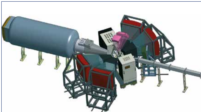
Obr. 3. Projekt neutronového difraktometru BEER (Beamline for European materials Engineering Research) pro materiálové inženýrství (Zdroj: Ústav jaderné fyziky AV ČR).
